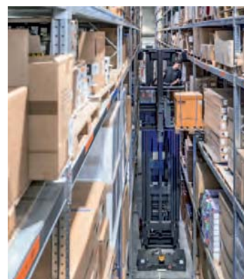
Das Linde-Assistenzsystem Dynamic Reach Control stabilisiert die K-Geräte seitlich beim Ausschieben der Last.
