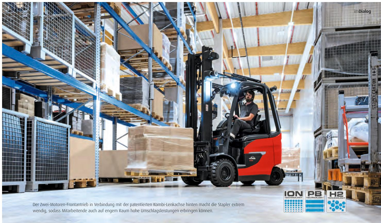
Der Zwei-Motoren-Frontantrieb in Verbindung mit der patentierten Kombi-Lenkachse hinten macht die Stapler extrem wendig, sodass Mitarbeitende auch auf engem Raum hohe Umschlagsleistungen erbringen können.
