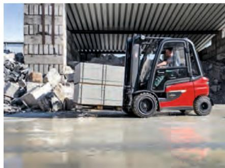
Auch auf unebenen Untergründen fühlt sich der Linde X20-X35 wohl und ermöglicht Bedienenden maximal ergonomisches Arbeiten. Verantwortlich dafür sind der lange Radstand und die großen Reifen in Verbindung mit der durch ein Elastomer-Ringlager schwingungsentkoppelten Antriebsachse.
