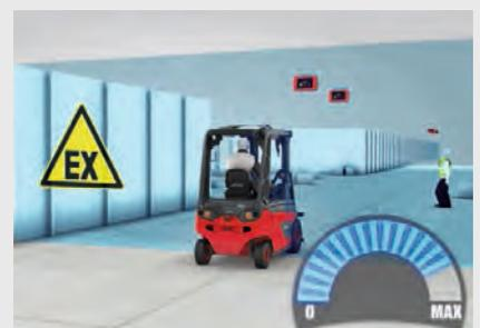
Das Assistenzsystem Linde Safety Guard für Ex-geschützte Flurförderzeuge der ATEX-Zonen 2/22 bremst Fahrzeuge automatisch ab, wenn sie sich zu nahe kommen oder in einen vorher definierten Bereich einfahren.
