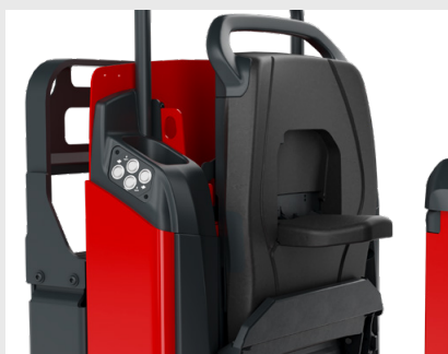
Höhenverstellbare Rückenlehne mit klappbarem Fahrersitz
