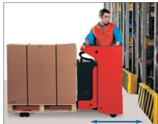
Nahezu gleicher Bremsweg, ob Fahrzeug unbeladen oder beladen.
